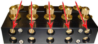
Beispiel Stellschrauben für Mediumregulierung / example adjusting screw for medium regulation
